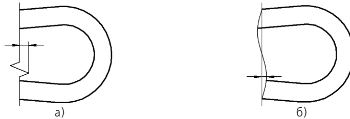
Рис. 51.6. Амплитуда: а) линии с изломом, б) волнистой линии (серым цветом показана средняя линия)
