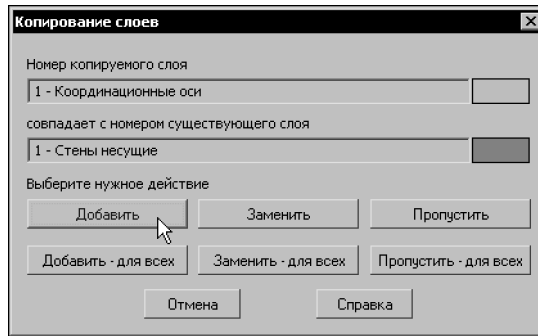
Рис. 47.3. Предупреждение о совпадении номеров слоев
