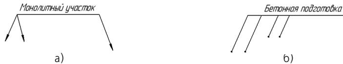
Рис. 28.12. Ответвления линии-выноски: а) от начала и от конца полки, б) параллельные
