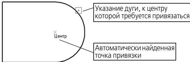
Рис. 8.11. Использование привязки **Центр** для указания центра отверстия
