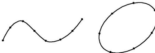
Рис. 10.1. Пример деления кривых (замкнутой и незамкнутой) на равные части
