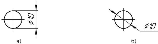
Рис. 27.1. Размер окружности: а) линейный, б) диаметральный
