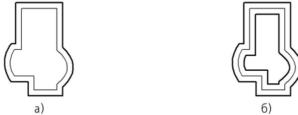
Рис. 21.3. Эквидистанта: а) с одной стороны от базового объекта, б) с двух сторон
