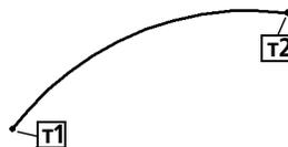
Рис. 15.5. Дуга по двум точкам и углу раствора  $60^\circ$
