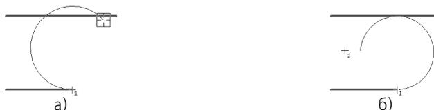
Рис. 19.14. Построение последующей дуги касательно к предыдущему сегменту и к произвольному объекту: а) выбор объекта, б) указание конечной точки
