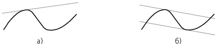
Рис. 11.6. Касательная к сплайну: а) проходящая через точку сплайна, б) имеющая заданный угол наклона
