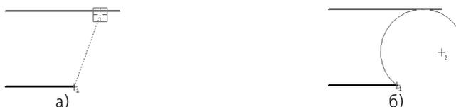
Рис. 19.15. Построение последующей дуги линии касательно к произвольному объекту: а) выбор объекта, б) указание конечной точки дуги
