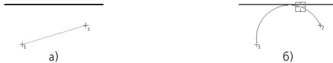
Рис. 19.12. Построение первой дуги линии касательно к объекту:
