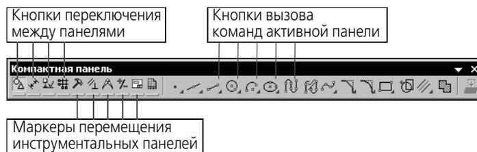
Рис. 1.6. Компактная панель при работе с графическим документом
