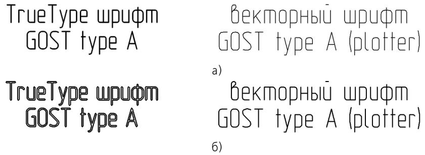
Рис. 34.5. Преобразование текстов в NURBS: а) исходные объекты – тексты, набранные TrueType-шрифтом и векторным шрифтом, б) результаты преобразования
