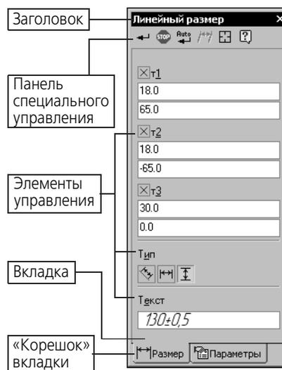
Рис. 1.2. Пример Панели свойств
